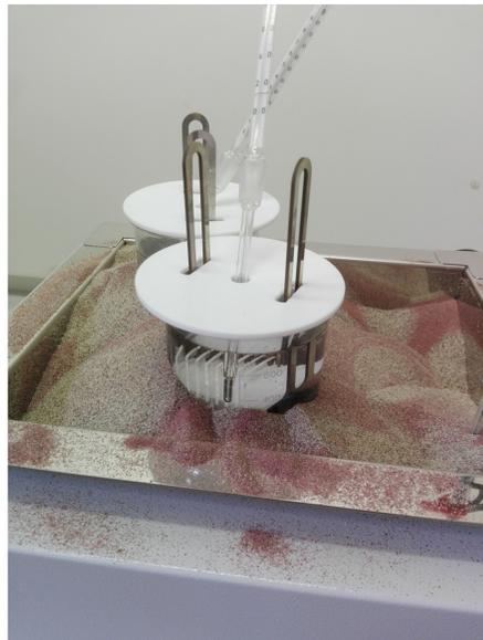
*Bagno Termostatico con becher di NaOH e dosimetri*
