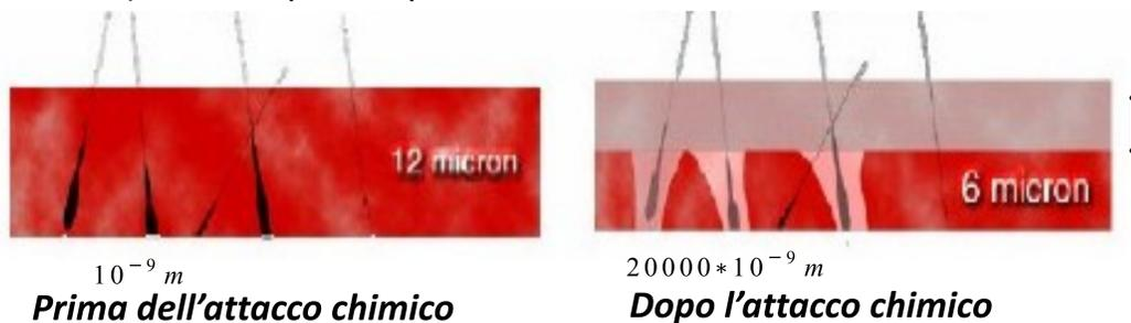
Per questo motivo si è inserito i CR-39 in una soluzione di soluzione acqua deionizzata e NaOH (concentrazione sei molare) ad una temperatura di circa 83°C per 6 h. Per mantenere questa temperatura è stato utilizzato un **bagno termostatico**.
